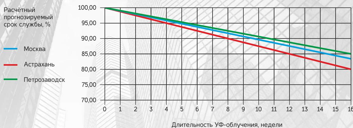
Для сохранения расчётного прогнозируемого срока службы рекомендуется в срок до 7 дней обеспечить защиту паро-гидроизоляции от воздействия прямого, рассеянного и отражённого УФ-излучения.
